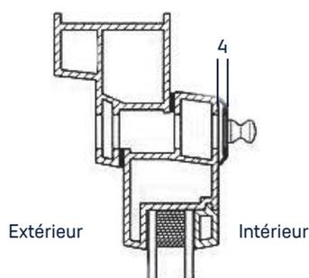
Ces grilles sont particulièrement adaptées pour être posées sur menuiserie, côté intérieur, sur des entailles standards de 250 x 15 mm ou 354 x 12 mm.
